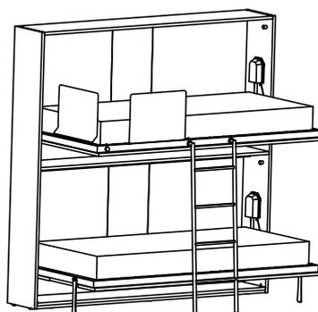
Scaletta: posizione fissa, come da schema, ha funzione di sostegno per la rete superiore. Protezioni: due (di serie) a quattro protezioni reclinabili per rete superiore; fino a due protezioni (opzionali) per rete inferiore. Rifacimento letto superiore: la rete superiore è reclinabile per agevolare il rifacimento del letto.
